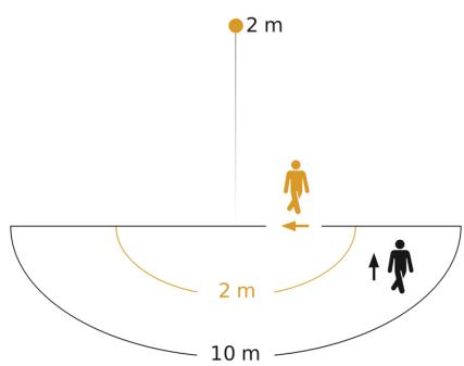
Possibile altezza di montaggio: 1,80 m – 2,00 m
